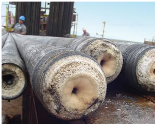
Отложения в трубах снижают эффективность нефтедобычи
