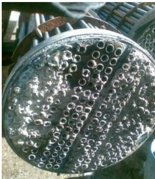
накись в теплообменнике нефтеперерабатывающего завода
