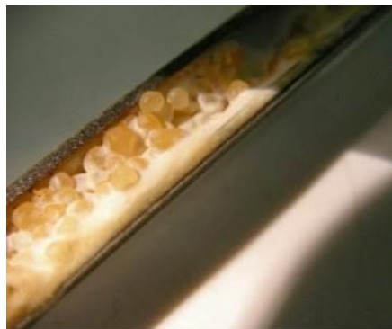
эффект жемчужины': шарики движутся в верхней части трубы, ниже жидкий парафин и вода
